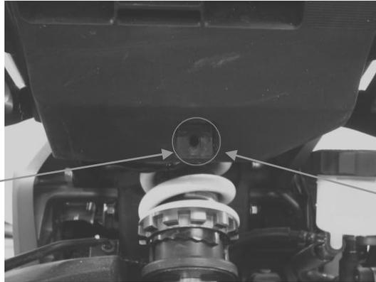
Point de fixation inférieur du passage de roue
