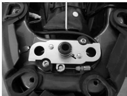
2° Position du système de verrouillage de selle
