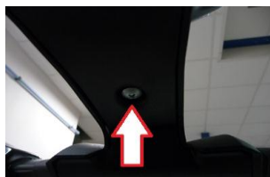
Vis cruciforme de la bavette
