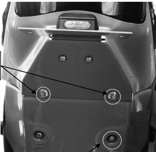
Vis de fixation du capteur atmosphérique
