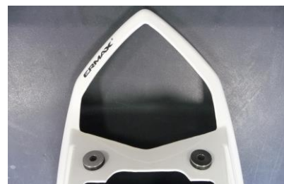
Position des silent bloc sur le passage de roue
